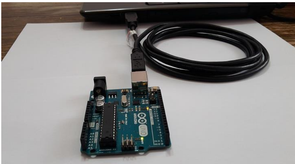
شکل ۳-۴: متصل کردن برد آردوینو از طریق کابل یو اس بی به کامپیوتر
