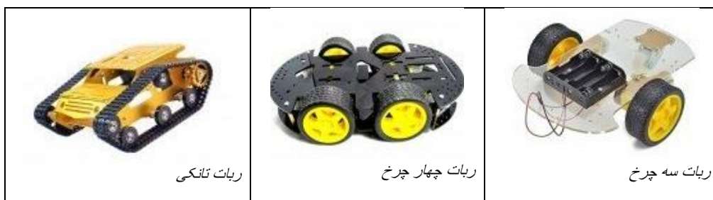
شکل ۱۱- ۱۲: نمونه هایی از شاسی های رباتهای چرخدار
