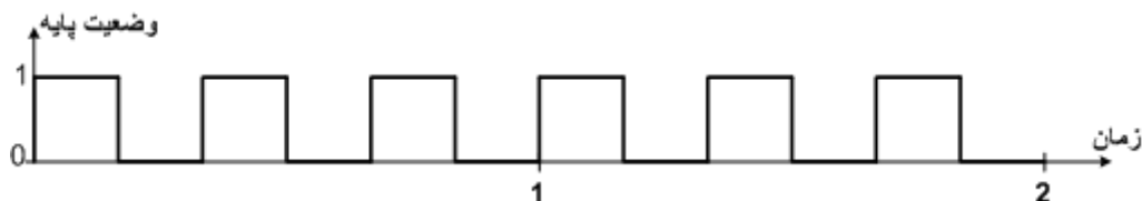
شکل ۱۲-۱: موج مربعی با فرکانس ۲ هرتز
