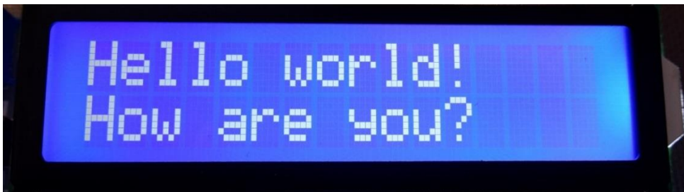
شکل ۸-۳: عکسی نزدیک از ال سی دی کاراکتری که در آن ۱۶ خانه و نقاط داخل خانه ها قابل دیدن است
