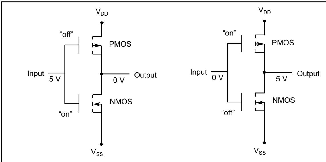
**Figure H-4. CMOS Inverter**
